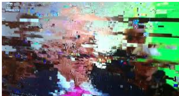
Abbildung 8 Verpixeltes Fernsehbild bei Störung des Empfangsweges
